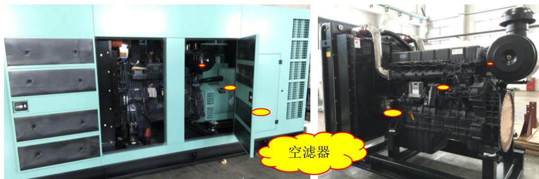
图 3-9 空滤器的布置位置
