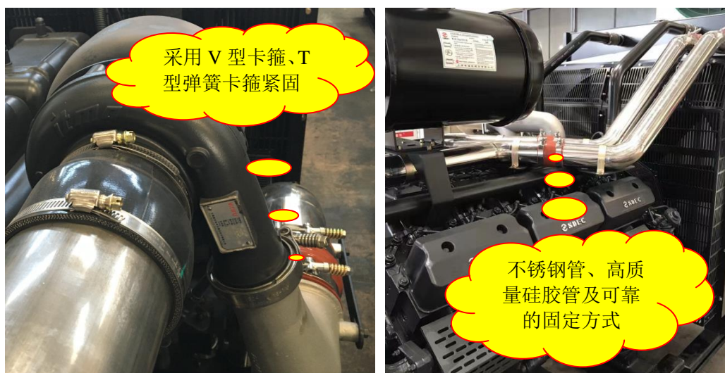
图 3-14 进气管路的布置方式
