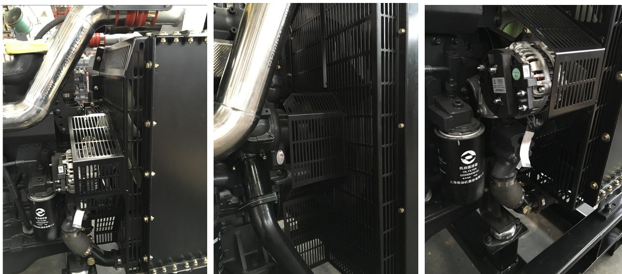
图 3-23 导风罩防护网
