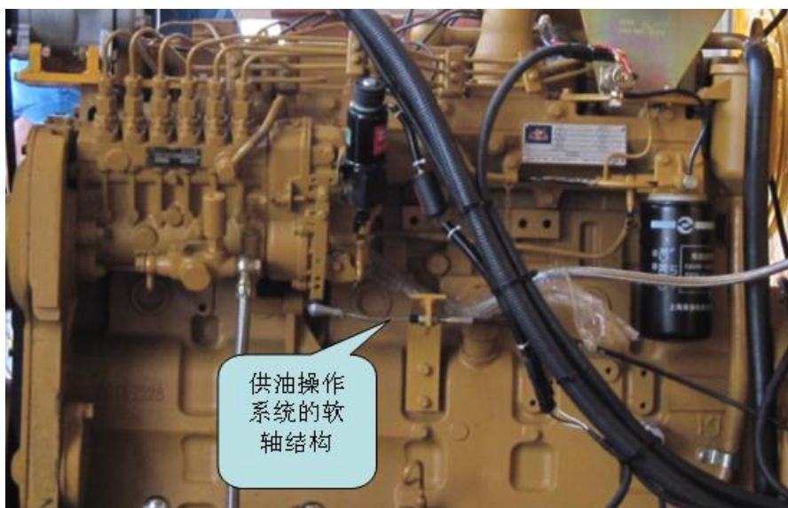
图 3-29 供油操作系统的软轴结构
