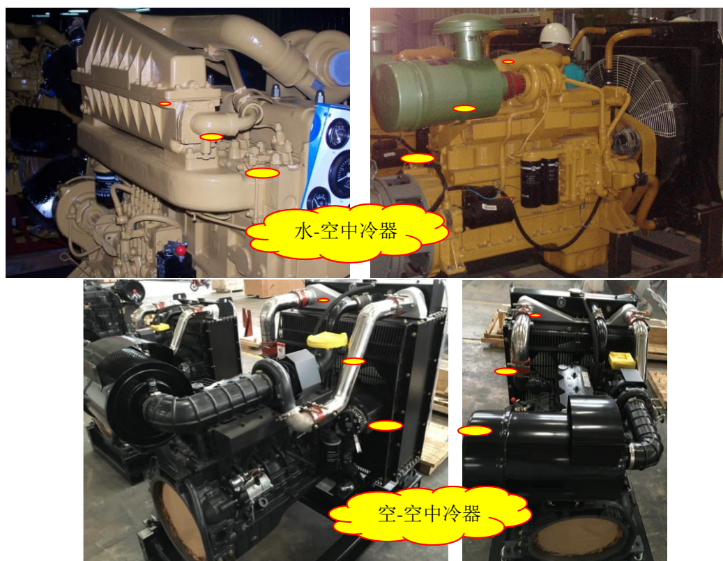
图 3-10 中冷器结构型式
