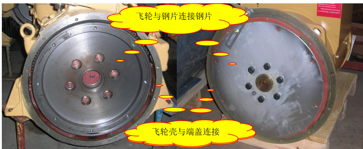
图 5-1 后端传动连接方式
