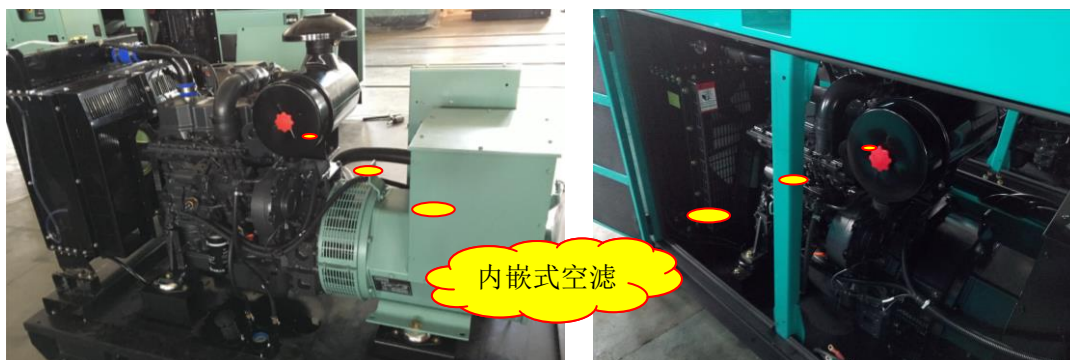
图 3-7 空滤的布置方式
