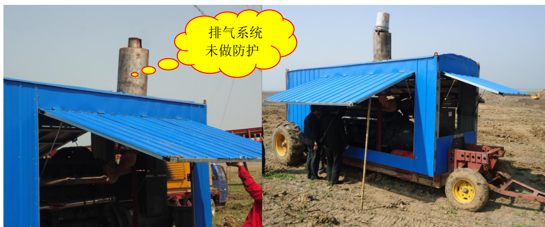
图 8-1 排气系统布置不合理
