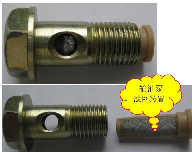
图 3-26 输油泵进油口滤网装置
